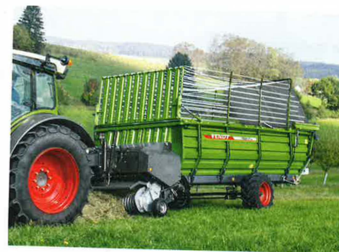
Tigo S und ST mit 22–29 m: Für das Berggebiet auch als Tieflader erhältlich.
