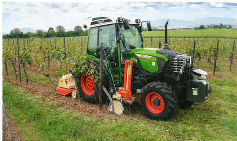
200er V/F mit vollautomatischer Steuerung der Traktor-Gerätekombination.
